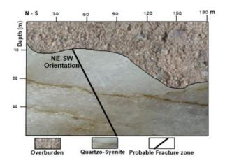
Fig. 7e Geomagnetic section of traverse 5.
